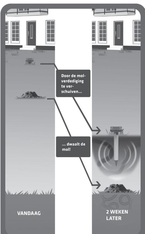
**Plaats de moleverdiging niet direct in de molsloop en schakel hem af en toe uit of verwijder hem van de grond om gewenning te voorkomen.**
